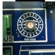
Repère 12 Sélecteur rotatif address (numéro de 0 à 9)
