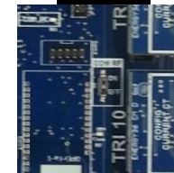
Repère 11 Slot Com RF On/Off
